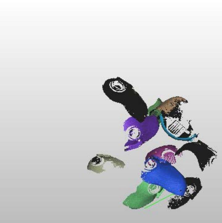
В процессе совмещения программа анализирует форму поверхности объекта и последовательно пытается совместить сканы друг с другом.
