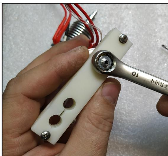
17. Снимите экструдер с планки.
