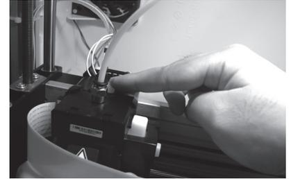
**3** Снимите экструдер. Высвободите экструдер, нажав белую кнопку в его задней части.
