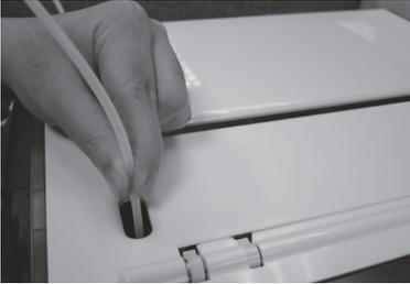
**1** Выведите направляющую трубку через зону перемещения трубки наружу из принтера, а затем вставьте свободный конец направляющей трубки в отверстие для трубки на подающем модуле.
