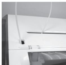
3 Совершая возвратно-поступательные движения чистящей щеткой, удалите из механизма подачи остатки нити. После очистки установите на место верхнюю крышку и направляющую трубку, соблюдая последовательность сборки.
