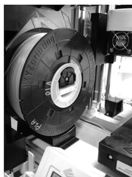
Сначала отведите рычаг фиксатора, затем вытяните нить и снимите катушку с нитью вместе со втулкой. Смотайте нить на катушку для дальнейшего использования.
