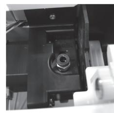
1 Удалите винт при помощи отвертки и откройте верхнюю крышку.
