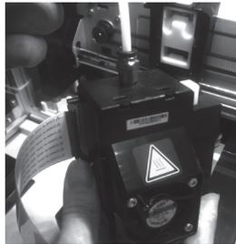
**5** Установите экструдер. Совместите экструдер с кронштейном и прижмите его, чтобы закрепить на держателе.
