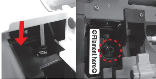
**2** Проверьте надежность установки направляющей трубки для нити в подающее отверстие.
