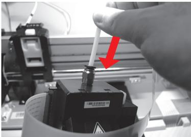
**4** Подсоедините к экструдеру направляющую трубку для нити. Вставьте направляющую трубку до упора в подающее отверстие и установите экструдер в принтер.
