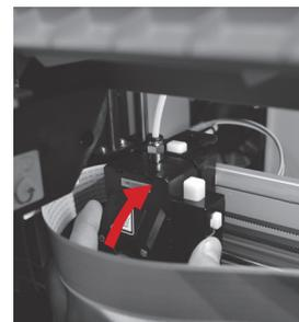
7. После чистки тракта подачи нити снова подсоедините направляющую трубку к верхней части экструдера и установите экструдер на кронштейн.
