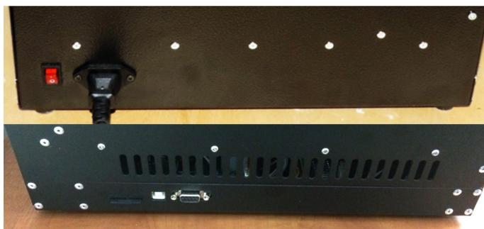
3. Через USB-кабель (гнездо USB находится на левой плоскости основания корпуса принтера) подключите печатающее устройство к вашему ПК.
